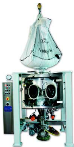
Big-Bag-Entleerung mit Endlos-Foliensystem in Glove-Box
