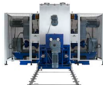
PP 500 Durchsatz bis zu 10000 kg/h pro Schnecke Schneckenanzahl variabel: 1, 2 oder 4 möglich Serienmässig mit patentiertem Combi-Vent-Feeder® Option: Gekühlte Walzen
