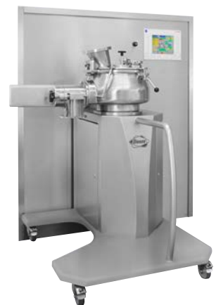
P/VAC 10-80 RC Schneller Behälterwechsel zwischen 10 und 80 l
